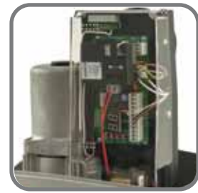
Vor Kablierte Motorsteuerung an Board Built-in control panel
